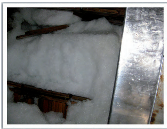
Figura 50. Hielo en la bodega, compactado y bien estibado
