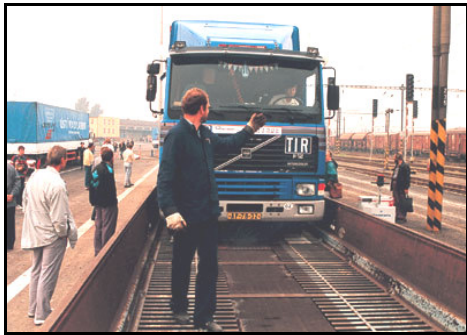
Procés de càrrega d'una carretera rodant
