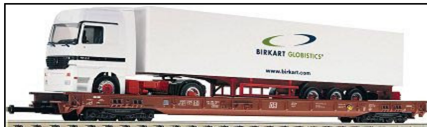
Vagó de plataforma rebaixada
