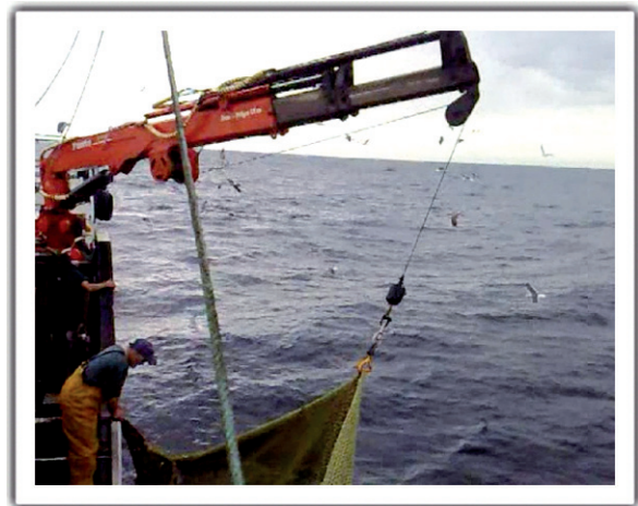
Figura 9. Apertura de copo con grúa
